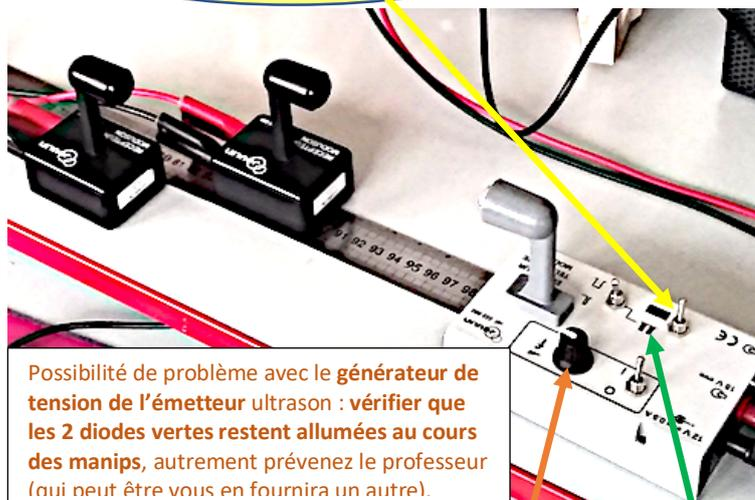
Possibilité de problème avec le **générateur de tension de l'émetteur ultrason** : vérifier que les 2 diodes vertes restent allumées au cours des manips, autrement prévenez le professeur (lui ne peut être vous en fournira un autre).
